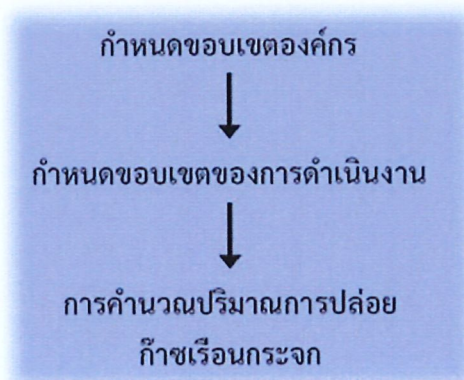
ภาพที่ 1 ขั้นตอนการประเมินก๊าซเรือนกระจกขององค์กร
