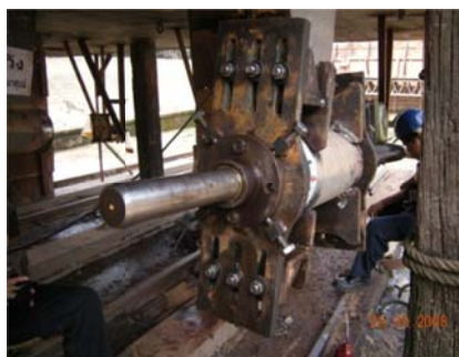
การหาศูนย์คว้านโยงโย้ เมื่อกำการหาศูนย์เส้นลวดผิดเกินเกณฑ์
